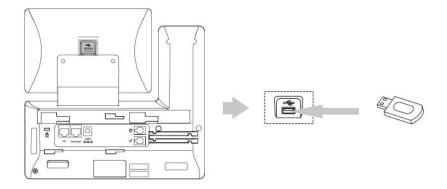
Remarque : Le port USB peut également être utilisé pour connecter le module d'extension à écran couleur EXP50, le casque USB ou le dongle DECT DD10K.
